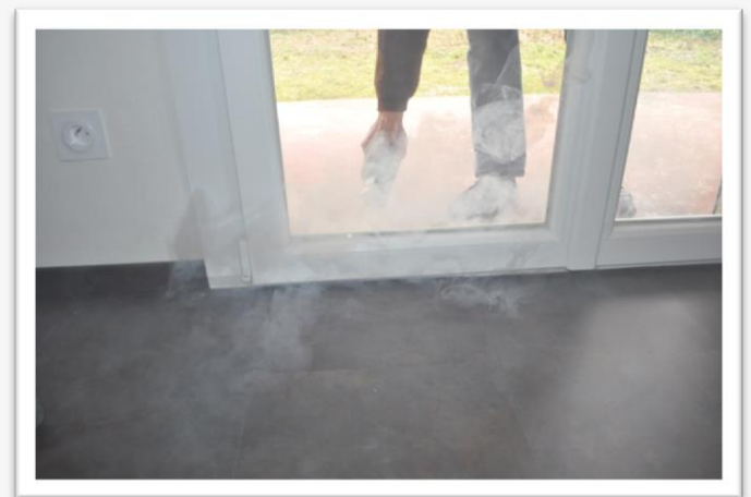
Recherche de fuites avec fumigène, Source Ajena
