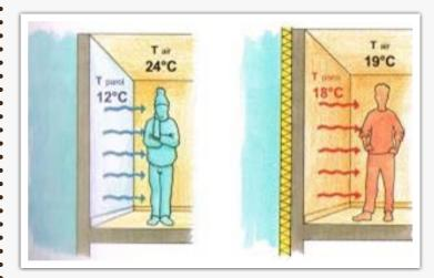
L'isolation des murs par l'intérieur s'est généralisée du fait de l'application de la réglementation thermique et globalement, si l'isolation a été bien réalisée, la sensation de paroi froide a disparu. Un mur, même peu isolé, garde une température proche de celle de l'air intérieur et participe donc au confort thermique.
